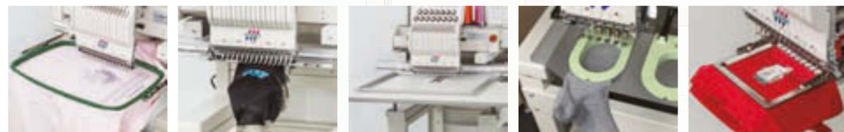
▲ Telaio Tubolare (Standard) ▲ Telaio per cappelli ▲ Border frame ▲ Telaio per calze ▲ Telaio pneumatico Clamp
